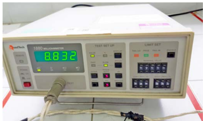
ภาพประกอบที่ 18. วัดค่าความต้านทานจุดต่อฯ ด้วยเครื่อง Milliohm meter
