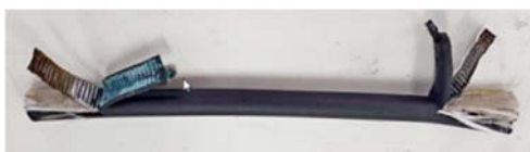
ภาพประกอบที่ 16. สายตัวอย่าง ARSS OFC เพื่อวัดค่าความต้านทาน Corrugate Armoured Steel
