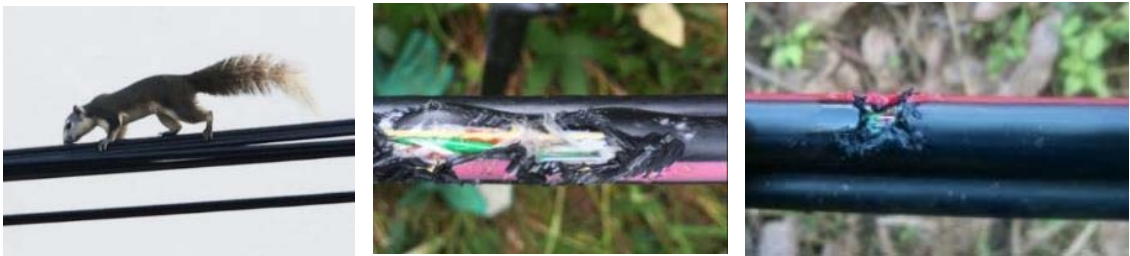
ภาพประกอบที่ 1. สายเคเบิล OFC ที่โดนกระจอกกัดแทะ
